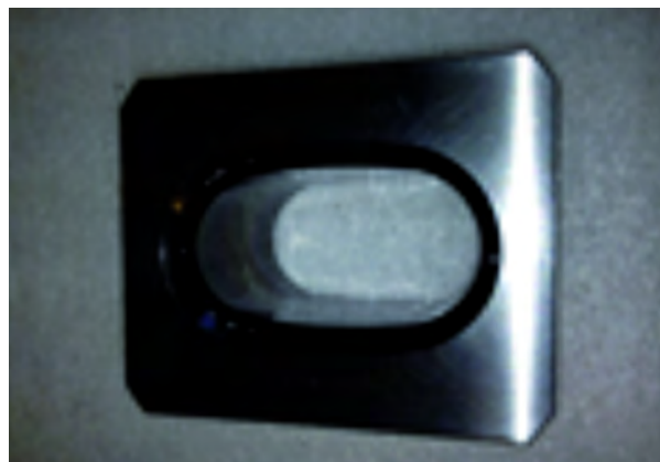
Fig. 9. Matriz extrusión de Al Recubrimiento DLC FORM.
