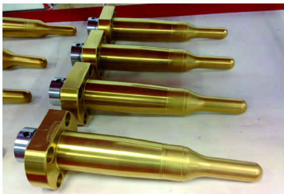
Fig. 6. Noios de acero inoxidable templado recubiertos TiN MOLT.
