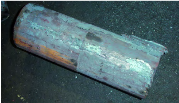
Fig. 4 a) Licuación en frontera de grano (fusión incipiente).
