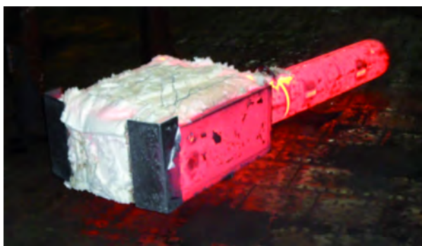
Sistema PhoenixTM unido a lingote de acero.
