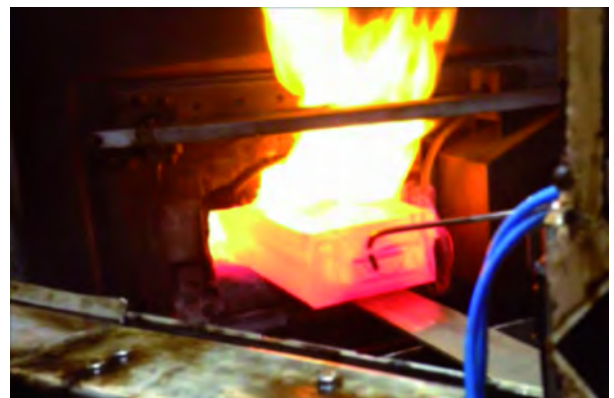
Sacando el sistema PhoenixTM del horno rotatorio.
