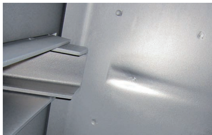
Desgaste en la zona directa de granallado.
