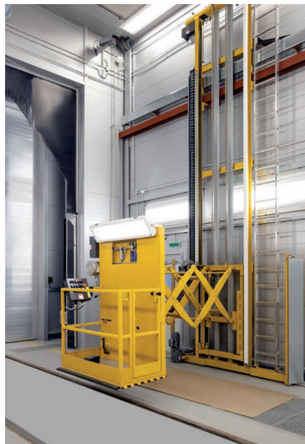
Plataformas de tijera para labores de reparación en zonas de difícil acceso.
