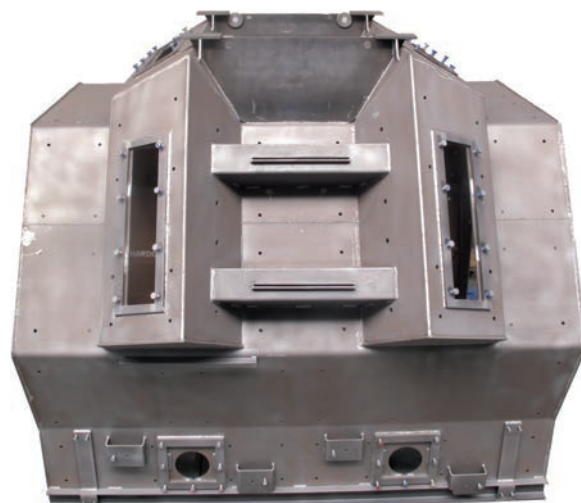
Cámara de granallado de acero al manganeso.
