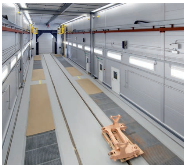
La compartimentación de la cabina de pintura permite ahorrar energía y trabajar de un modo eficaz.
