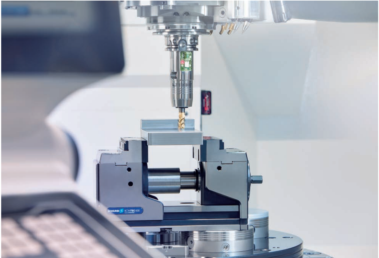
El smart iTENDO permite la supervisión y el control del proceso en tiempo real directamente en la herramienta. Los datos de geometría y rendimiento de los portaherramientas permanecen inalterados incluso con los sensores. Foto: SCHUNK.
