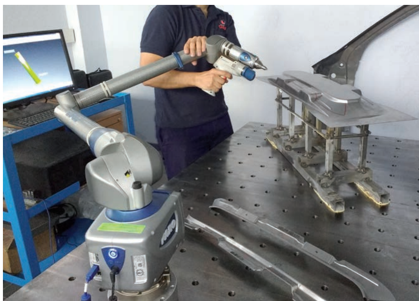
Aplicación del Faroarm en el proceso de control de calidad de la pieza.
