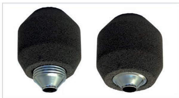
Figura 5: Nuevo concepto antes y después de la compactación: habitualmente distancia de 8 a 15 mm entre el cuerpo principal del manguito y la colada.
