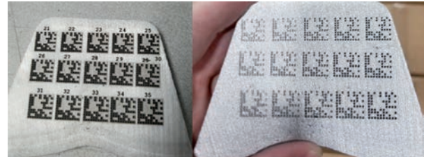
Figura 14: DMC con tamaños de celda que van de 0,85 mm a 0,95 mm antes y después del procedimiento de granallado.
