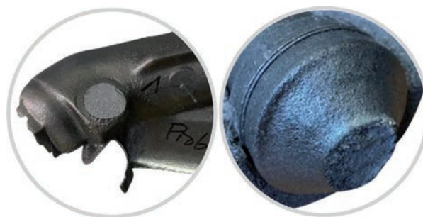
Figura 7: Resultado del corte de la mazarota con el nuevo concepto de sistema de alimentación novedoso: pieza que no requiere virtualmente ningún otro trabajo de desbarbado.
