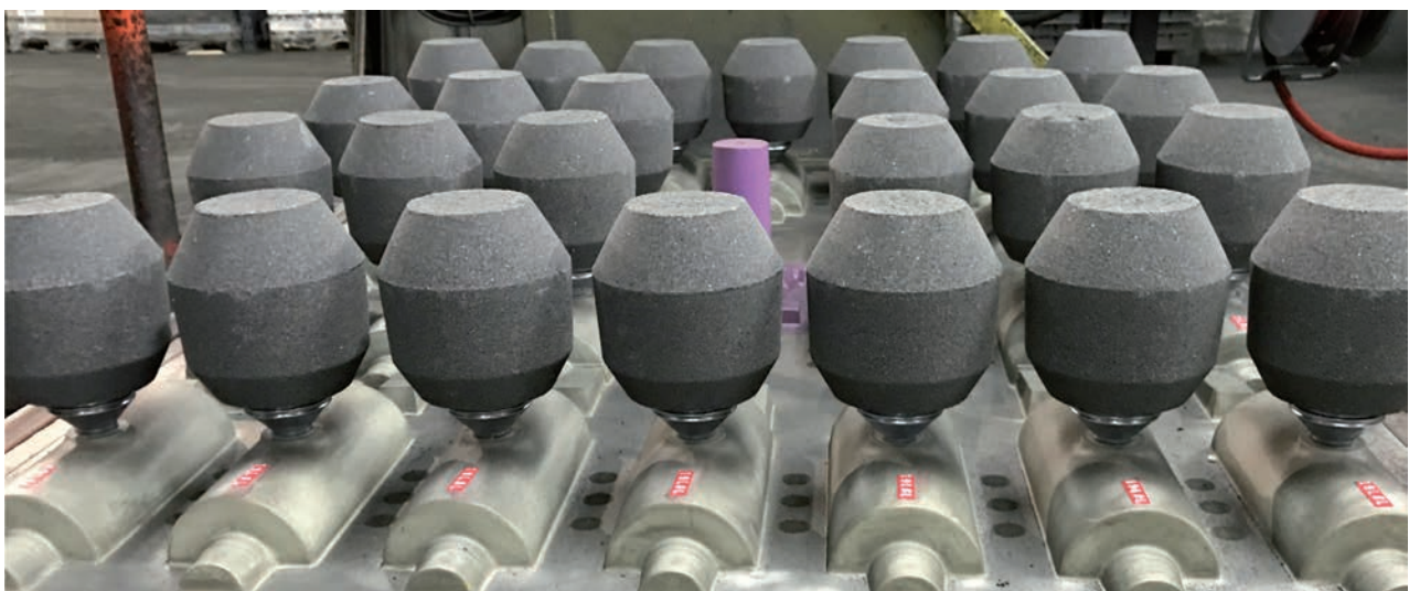
Figura 3: Aplicación de FEEDEX VAK aprovechando las ventajas del menor volumen.
