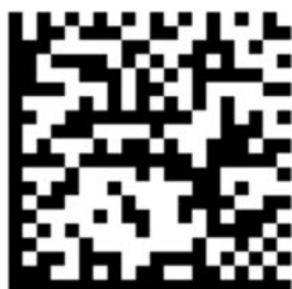
[TB1] Figura 1: Ejemplo de código de matriz de datos (DMC) con la dirección web de Laserax codificada en él.
