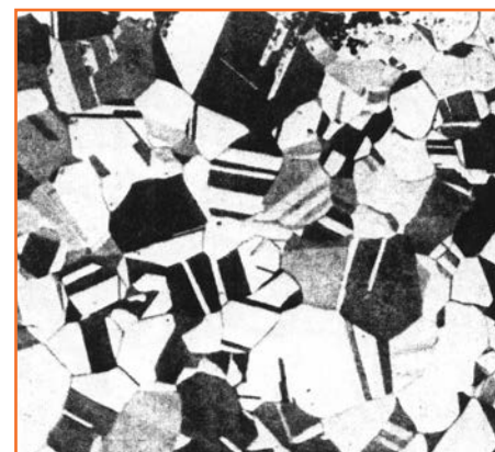
Figura 2.3. Microestructura de un latón 70 Cu-30Zn, estirado en frío y recocido a una temperatura de 750 °C durante 30 minutos. Se observa un tamaño de grano relativamente grueso, debido a la alta temperatura de recocido, mostrando los nuevos granos un maclado pronunciado.
