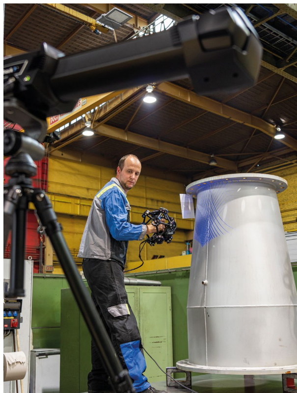
MetraSCAN escanea un segmento de tubería de una planta de altos hornos.
