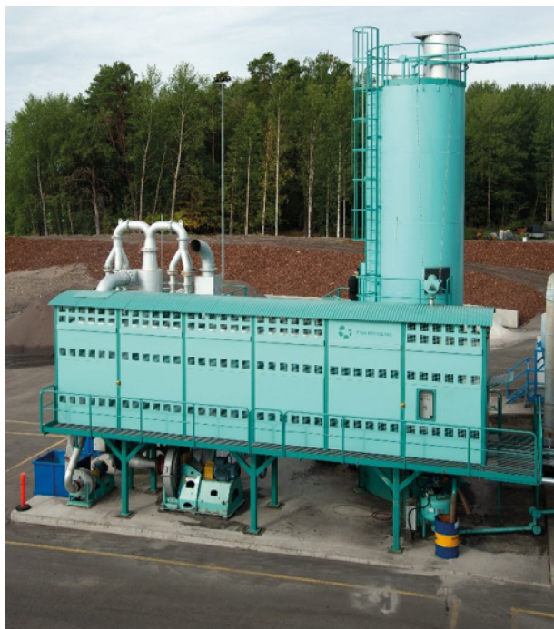
Figura 4: Regeneración de arena como servicio: en la planta de Nuutajärvi de Finn Recycling o en una instalación externa modular en el sitio de fundición.
