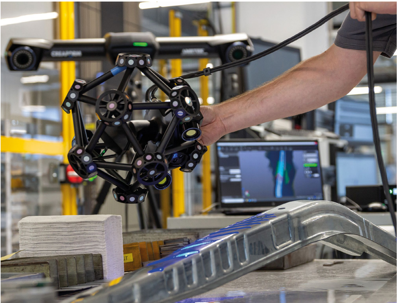
Escáner MetraSCAN 3D escaneando una pieza de chapa metálica. En segundo plano puede verse el registro en tiempo real del escaneado en una computadora portátil.
