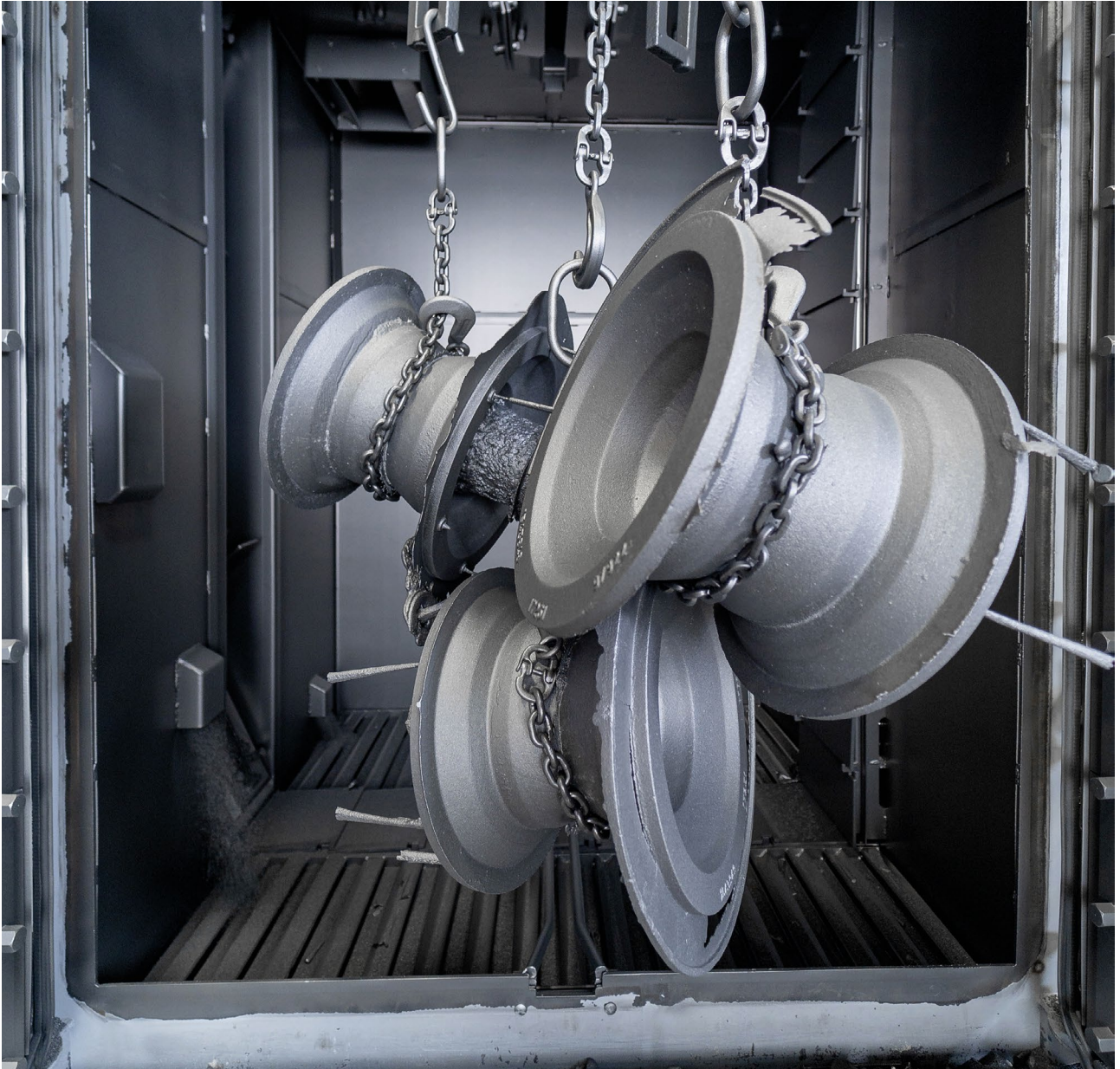
Piezas después del proceso de granallado en una granalladora tipo suspensión AGTOS
