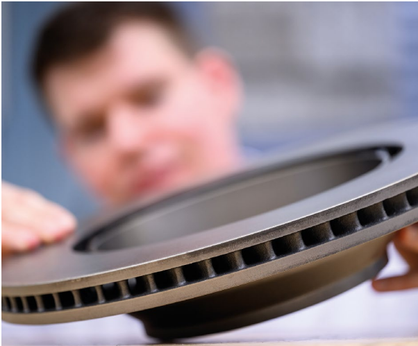
Discos de freno recubiertos. Con HS-LMD, la industria automotriz puede recubrir los discos de freno, para que sean más resistentes y apenas produzcan emisiones de partículas. (Fuente: TRUMPF)
