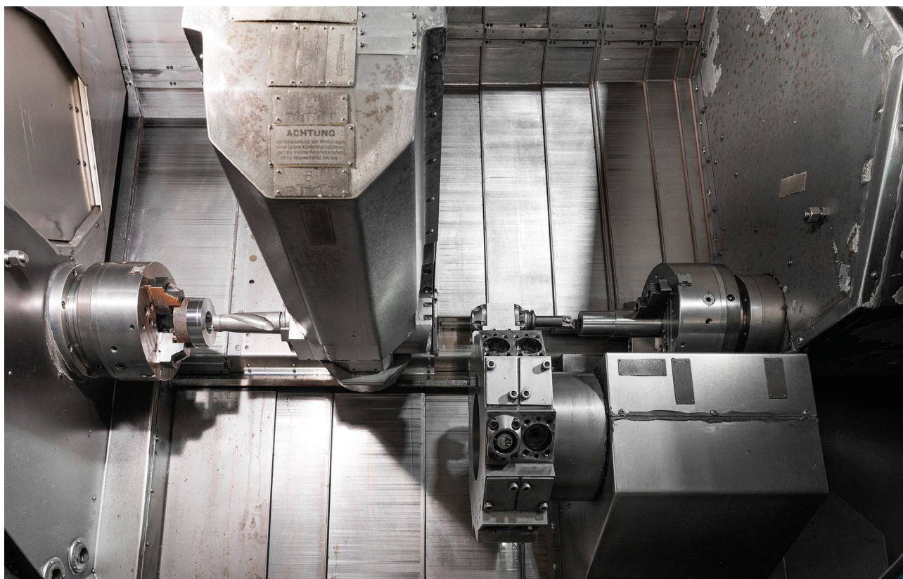
Hasta nueve ejes de mecanizado, incluida la posibilidad de interpolación de 5 ejes, ya era posible en WFL hace 25 años. El diseño con torreta inferior y contrahusillo permitió la máxima productividad y flexibilidad.
