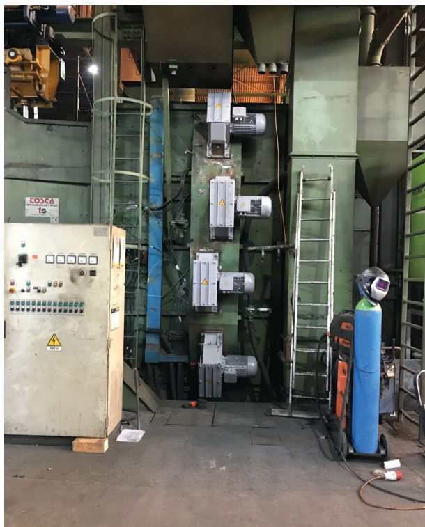
Tres nuevas turbinas AGTOS de alto rendimiento en la máquina de granallado con transportador aéreo modernizada.
