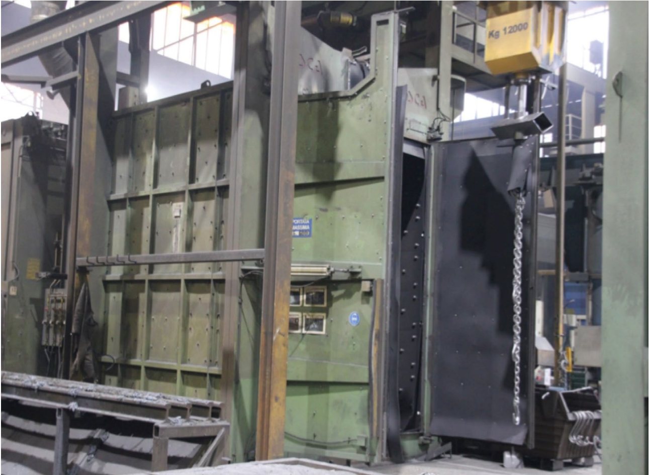
Vista de la granalladora de transportador aéreo modernizada por AGTOS.
