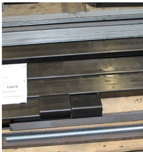
Fig. 3 y 4 Piezas de acero grasientas antes del tratamiento superficial.
