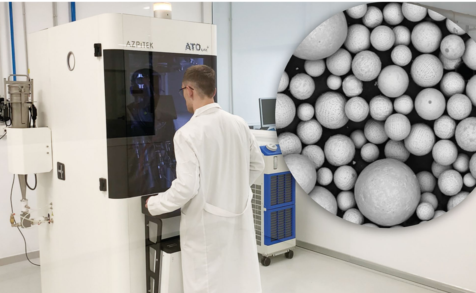
Proceso de atomizado de los polvos metálicos NiTi, utilizados para el desarrollo de la pintura aplicada en la cavidad de los moldes, en las instalaciones de AZTERLAN.
