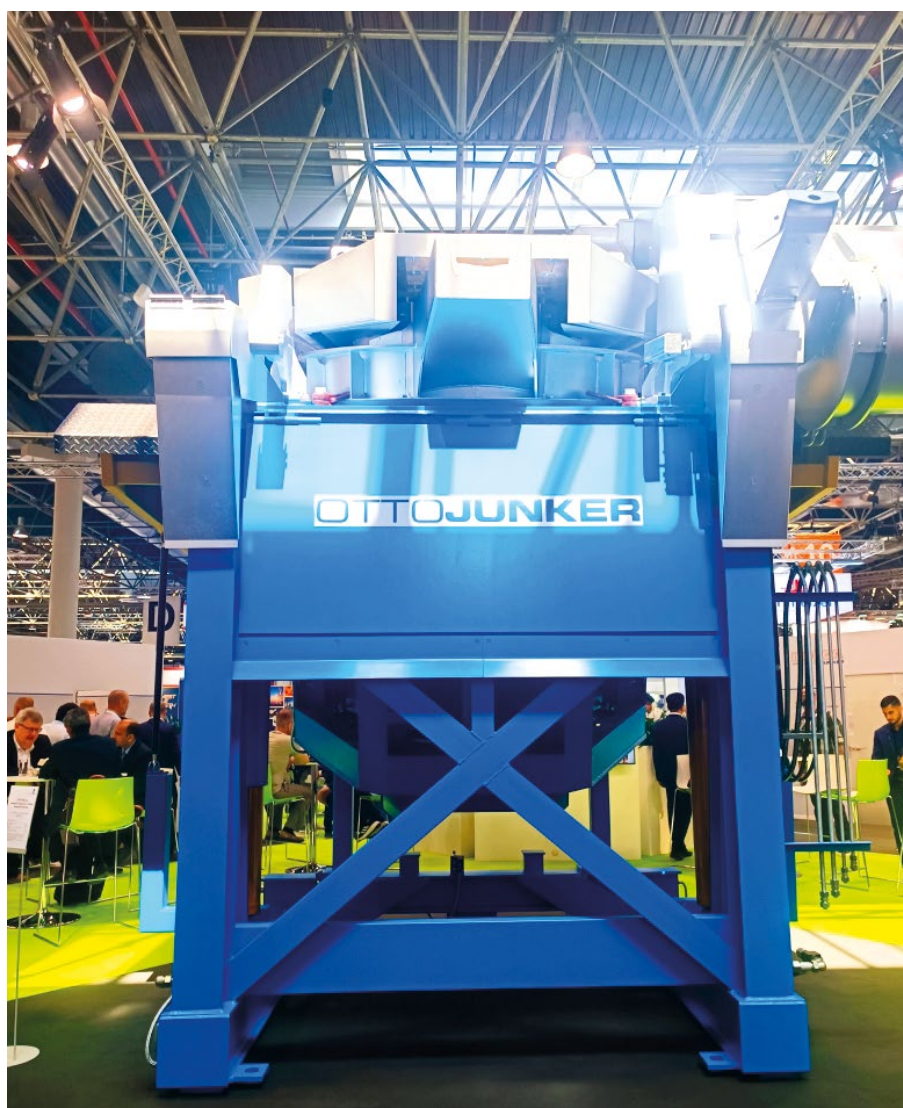
Horno de inducción sin núcleo de media frecuencia para hierro fundido 8.000 / 6.100 kW / 250 Hz MONOMELT.
