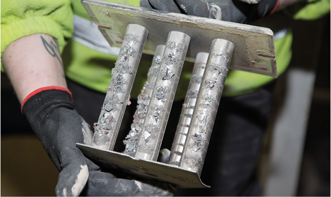
Metal ferroso en plástico reciclado capturado en imanes de tubo.
