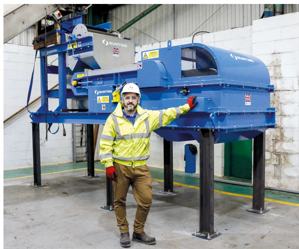
Módulo separador de tambor magnético y corrientes de Foucault en HML Recycling.
