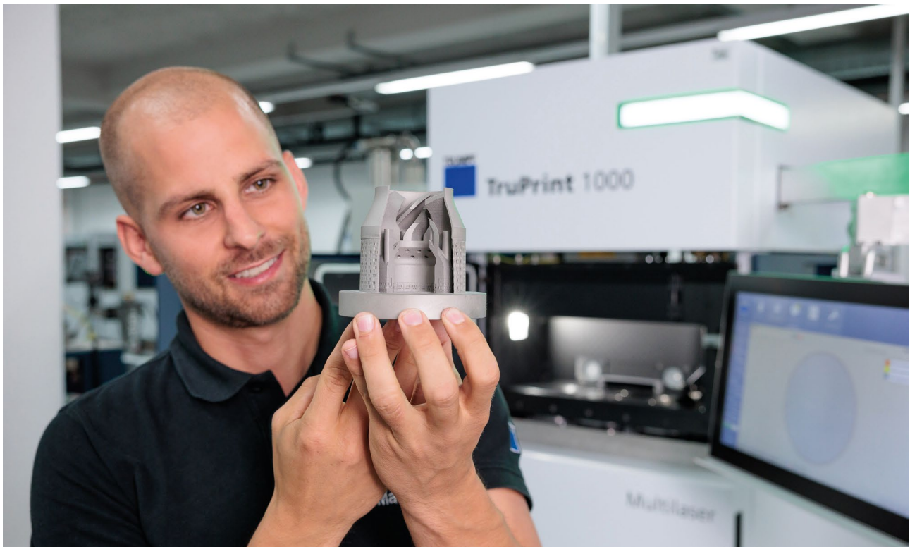
Impresión 3D sin soporte. Las ventajas de la impresión sin soporte son particularmente atractivas para piezas que presentan grandes cavidades o voladizos desafiantes.
