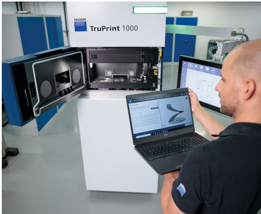
Piezas con voladizos extremos. TruTops Print permite a los usuarios imprimir piezas con voladizos extremos de hasta 15 grados sin necesidad de estructuras de soporte.
