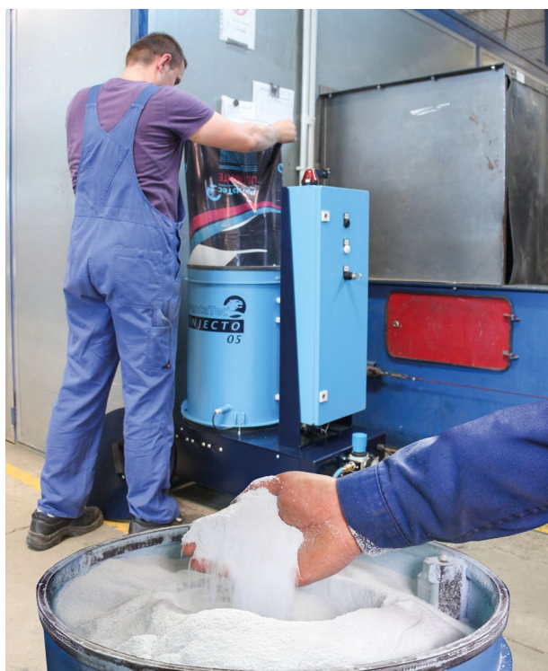
Fiabilidad del proceso: El INJECTO 05 garantiza una dosificación constante y homogénea según los requisitos individuales del proceso de granallado.
