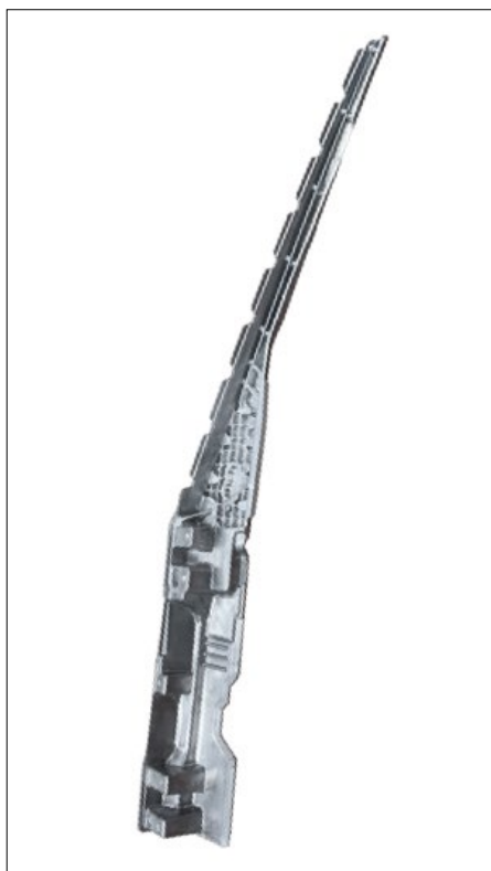
Fig. 1: Rheocasting de pilar de bisagra de Rivian.
