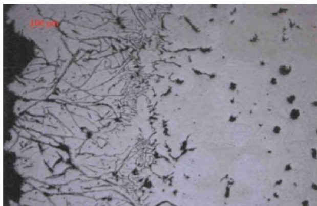
Degeneración del grafito hasta una profundidad de 500 µm desde la superficie de la pieza cuando se utiliza un sistema convencional de furano.
