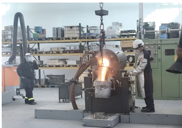
La Unidad de Tecnologías Avanzadas de AZTERLAN cuenta con una planta piloto de fundición, capacidades para el diseño de componentes, fabricación de moldes y machos de arena mediante tecnologías de impresión 3D y capacidades de simulación (programas de software propios y programas comerciales).
