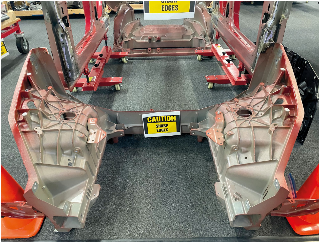
Figura 1: Un Giga-casting del Model Y de Tesla (Fuente: S. Munro).
