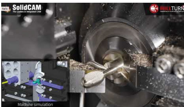
SolidCAM Swiss-Type – Mecanizado de útil para medicina.
