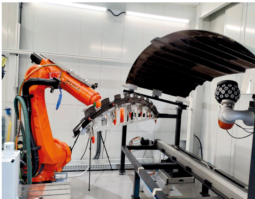
Célula de ensamblado de piezas aeronáuticas – Cortesía de IDEKO.
