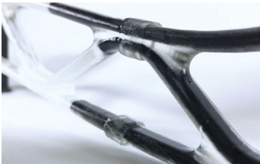
Tecnología de proceso de inyección continua de fibras (CFIP) - Cortesía de REINFORCE3D.
