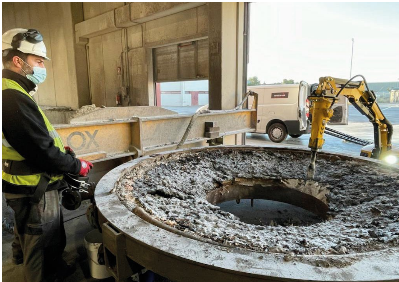
Limpieza de cucharas con robot a control remoto.
