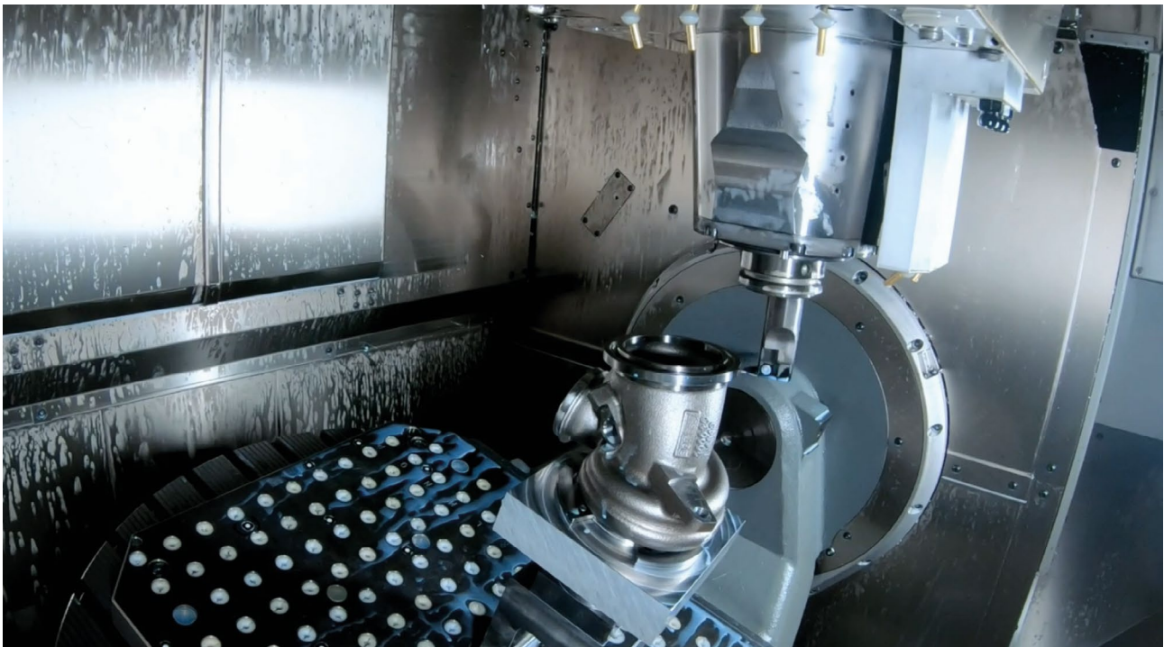
AC Tech, cliente de Tebis, fabrica superficies con simetría de rotación un 80% más rápido gracias al torneado por interpolación.
