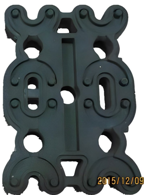
a) Pieza de macho único para el método Shell.
