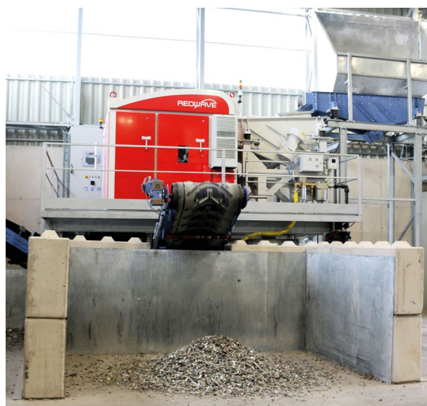
Las máquinas de clasificación XRF de REDWAVE clasifican por composición química, recuperando metales pesados mixtos y separándolos en monofracciones metálicas como cobre, latón o zinc.
