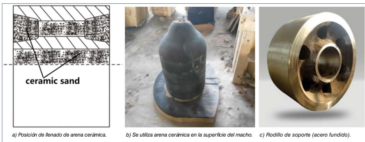
Fig.8 Moldeo y fabricación de machos con silicato de sodio (Soporte de rodillos. Fundición de acero).
