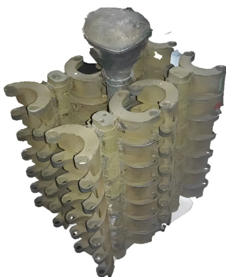
b) Piezas fundidas con sistema de racimo sistema Shell.
