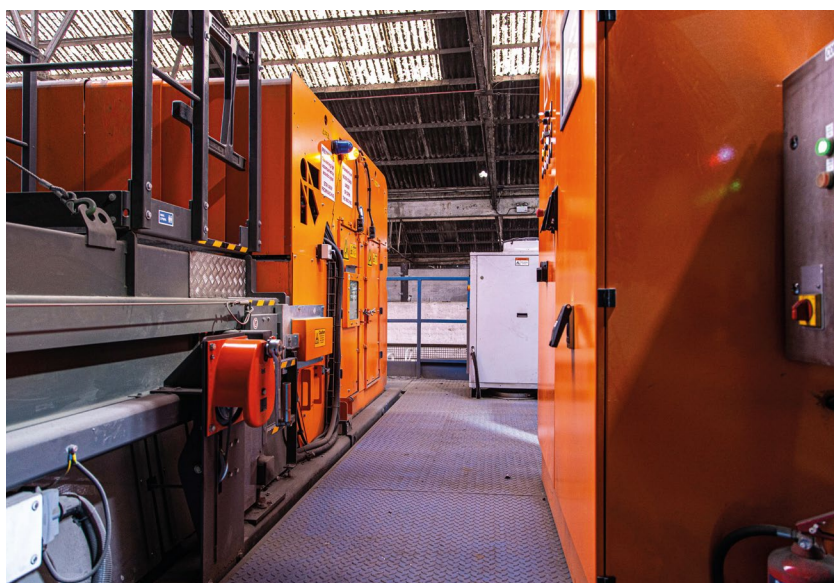
La solución de XRT X-TRACT® de TOMRA Recycling lleva más de dos décadas en el mercado y es ideal para separar metales pesados del aluminio.
